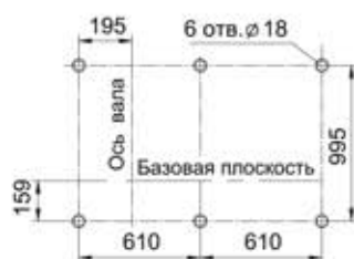
Расположение отверстий для крепления вентилятора
