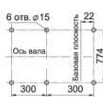
Расположение отверстий для крепления вентилятора
